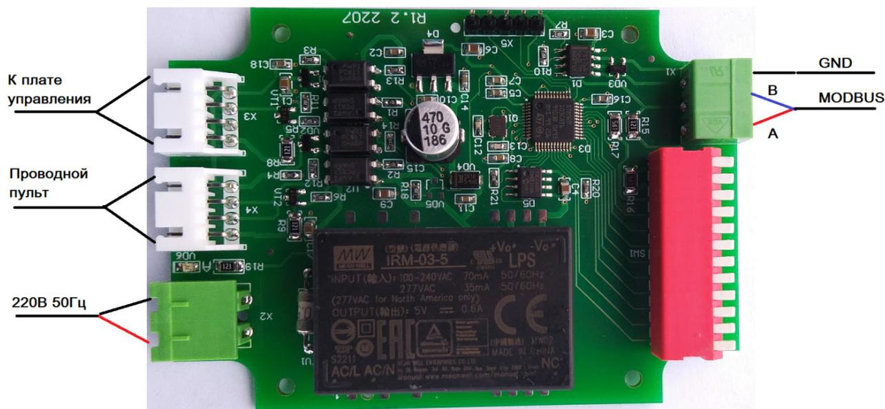
Для подключения к внутренним блокам РАС системы используется кабель для подключения к плате управления кондиционером прилагаемый к устройству и штатный кабель, поставляемый вместе с пультом управления. Питание устройства осуществляется от сети переменного тока напряжением 180В-250В. Потребляемая мощность от питающей сети не более 3Вт. Все сигнальные интерфейсы имеют гальваническую развязку от питающей сети так и между собой.
